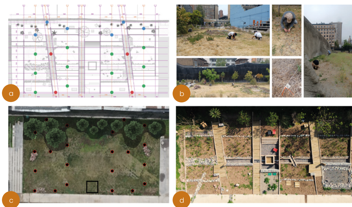
Ejemplo de una grilla de puntos para la definición del monitoreo microclimático. En este caso, el trazado predefinido en planos, (a) la medición situación ex ante ( b y c) y ex post(c):
