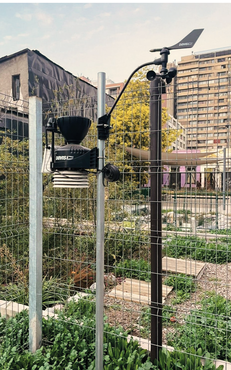
Figura 2: Imagen de referencia de estación meteorológica instalada con sensores a 2 m de altura, con delimitación de área de seguridad
